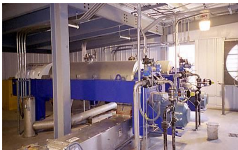
Сурет – 4. Барда өңдеу цехындағы Декантерлік центрифугалары
