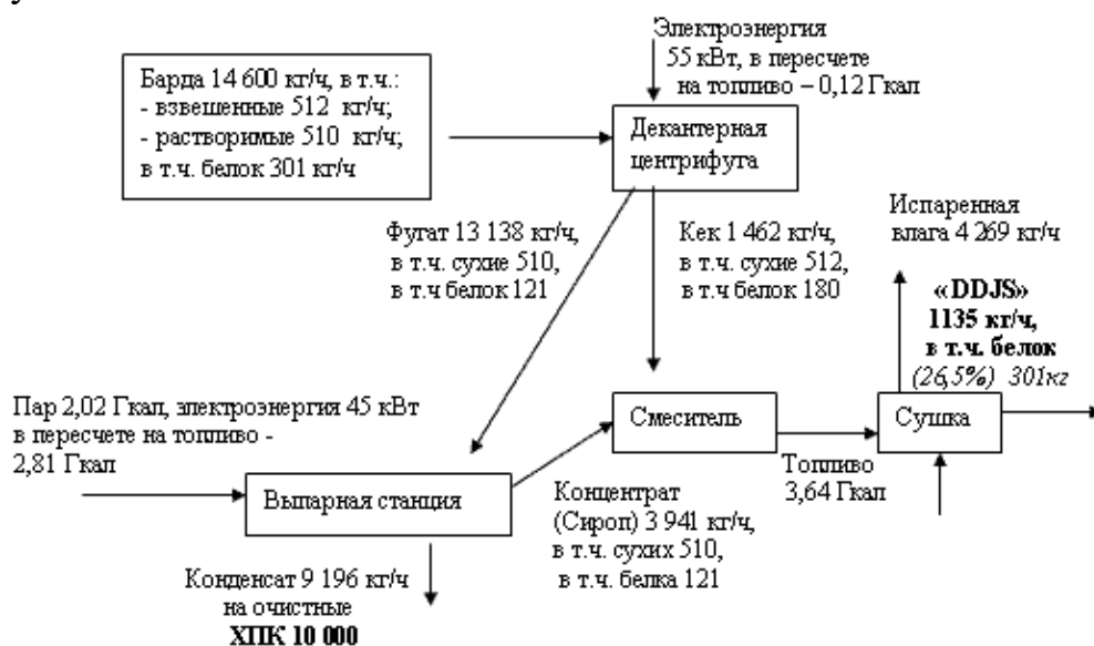
2-сурет ."DDGS"ішіндегі барданы қайта өңдеудің жеңілдетілген схемасы
